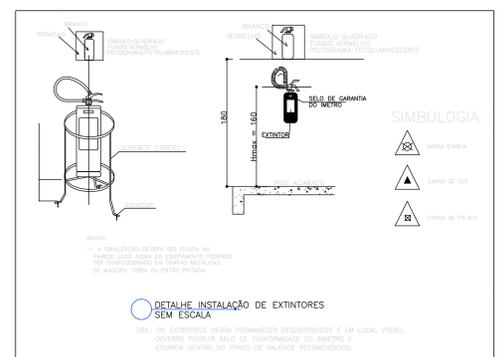
DETALHE INSTALAÇÃO DE EXTINTORES SEM ESCALA
